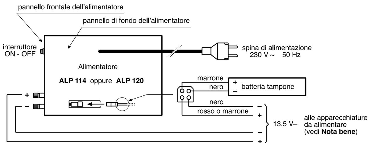
**Nota bene:** la tensione di 13,5 V- di alimentazione delle apparecchiature può essere presa, secondo la convenienza, dalle due bocche del pannello frontale oppure dal connettore di collegamento della batteria tampone
